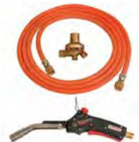
Handgriff mit Piezo-Zünder, Turbobrenner 17 mm, HD-Schlauch 2,0 m, G 3/8 LH, Regler 2,0 bar fest eingestellt mit Schlauchbruchsicherung für 5 + 11 kg Flaschen.
