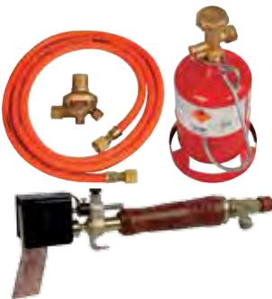
Handgriff Lomen Classic, Kolbenbrenner mit Kolbenhalter, Windschutz, Kupferstück 350 g, Hammerform gekröpft, HD-Schlauch 2 m, G 3/8 LH, Kleinregler 1,5 bar fest eingestellt, Kleinstflasche 425 g mit Aufhängehaken.
