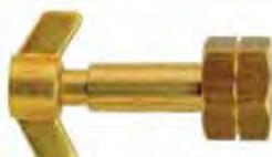
Für 5, 11 + 33 kg Flaschen, 6-Kant-Mutter W 21,8 × 1/14 LH, Führungstift, Flügelmutter G 3/8 LH, Vollmessing, Anschluss nach DIN 477, Zulassungszeichen 01 D 65 B.
