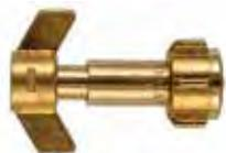
Für 5 + 11 kg Flaschen, Profilmutter W 21,8 × 1/14 LH, Führungstift, Flügelmutter G 3/8 LH, Vollmessing, Anschluss nach DIN 477, Zulassungszeichen 01 D 65 B.
