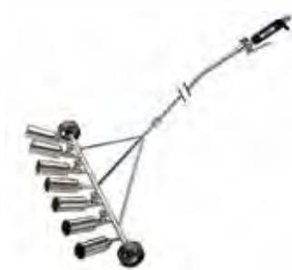
Handgriff Universal, Verbindungsrohr 600 mm, sieben Brennerköpfe, Edelstahl, ø 45 mm, abschraubbar, vier Brennerköpfen absperrbar, Arbeitsbreite 100 cm, Führungswagen mit Stahl-Laufrädern.
