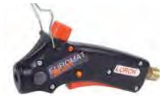
Piezo-Zündung und Momenthebelventil mit Arretierung, kombiniertes Hauptabsper- und Regulierventil, drehbarer Schlauchanschluss, Abstellbügel, Steck-/Rast-Mechanik als Brenneranschluss, Brenneinsatz um 360° drehbar.
