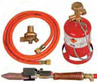
Handgriff Ignit, Kolbenbrenner mit Kolbenhalter und Piezo-Zünder, Windschutz, HD-Schlauch 2 m, G 3/8 LH, Kleinregler 1,5 bar, fest eingestellt, Kleinstflasche 425 g Füllmenge, mit Aufhängehaken.
