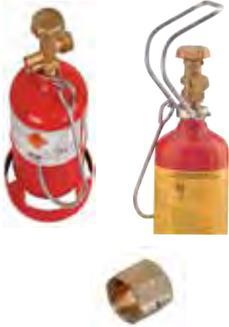
Füllmenge 425 g, geschweißt, Bauartzulassung, Prüfdruck 30 bar, Ventil mit Überdrucksicherung und Verschlusskappe, Anschluss G 3/8 LH, Aufhängehaken, Standfuß.
