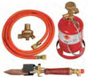
Handgriff Lomen Classic, Kolbenbrenner mit Kolbenhalter, Windschutz, Kupferstück 350 g, Spitzform, HD-Schlauch 2 m, G 3/8 LH, Kleinregler 1,5 bar, fest eingestellt, Kleinstflasche 425 g Füllmenge, mit Aufhängehaken.
