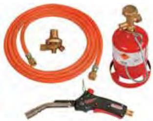
Handgriff mit Piezo-Zünder, Turbobrenner 17 mm, HD-Schlauch 2,0 m, G 3/8 LH, Kleinregler fest eingestellt auf 2,0 bar, Kleinstflasche 425 g Füllmenge, Aufhängehaken.
