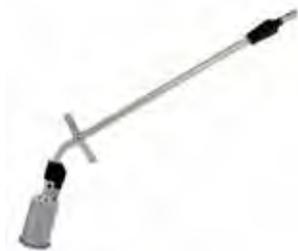
passend zu Handgriff Lomat Piezo 18 069, 18 754, Steck-/Rast-Anschluss, Brenneinsatz in Rasterschritten (60°) um 360° im Handgriff drehbar. Zündelektrode (Brennerkopf mit Piezozünder), Brennerkopf aus Edelstahl, Verbindungsrohr aus Edelstahl mit Zündleitung, Abstellfuß Nr. 23 101, Gasdruck 1,5 bis 4 bar.
