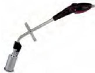
Handgriff Lomat Piezo 18 069, Steck-/Rast-Anschluss, Brenneinsatz in Rasterschritten (60°) um 360° im Handgriff drehbar. Zündelektrode (Brennerkopf mit Piezozünder), Brennerkopf aus Edelstahl, Verbindungsrohr aus Edelstahl mit Zündleitung, Abstellfuß Nr. 23 101, Gasdruck 1,5 bis 4 bar.
