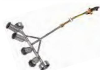
Handgriff Universal, Verbindungsrohr 600 mm, vier Brennerköpfe, Edelstahl ø 45 mm, abschraubbar, Arbeitsbreite 70 cm, Führungswagen mit Stahl-Laufrädern.
