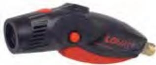
Ergonomischer Handgriff mit Multi-Funktionen, Piezo-Zündung und Momenthebelventil mit Arretierung, kombiniertes Hauptabsperr- und Regulierventil, Schlauchanschluss drehbar, G 3/8 LH, Steck-/Rast-Mechanik als Brenneranschluss, Brenneinsatz um 360° drehbar, integrierter Abstellbügel im jeweiligen Brenneinsatz.
