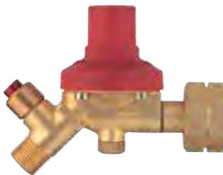
Passend zu 5, 11 + 33 kg Flaschen, mit integrierter Schlauchbruchsicherung, mit Dichtheitsprüfung für HDSchlauch DN 4, unter Erdgleiche einsetzbar, Anschlüsse nach DIN 477, DIN-DVGW geprüft.
