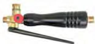
mit Momentehebel, kombiniertes Hauptabsper- und Regulierventil, einstellbare Zündflamme. Anschluss für Brenneinsätze: M 14 x 1 außen
