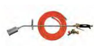
Handgriff Universal, Verbindungsrohr 600 mm, Brennerkopf mit Luftansaugung von hinten, 60 mm ø, Regler 4 bar fest eingestellt mit Schlauchbruchsicherung für 5 – 33 kg Flaschen, Abstellbügel.
