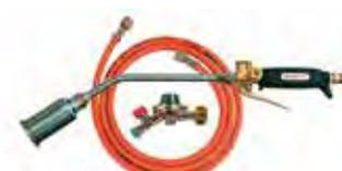
Handgriff Universal, Verbindungsrohr 230 mm lang, Brennerkopf Edelstahl ø 40 mm, HD-Schlauch 2 m, G 3/8 LH, Regler 1,5 bar, fest eingestellt, mit Schlauchbruchsicherung für 5 + 11 kg Flaschen.
