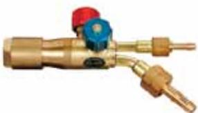
Zum Einspannen, für stationären Betrieb. Durchsatzleistung 30 m<sup>3</sup>/h, Anschluß: Sauerstoff 3/8" mit 6,3mm Tülle, Brenngas 1/2"l.h. mit 9mm Tülle.
