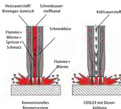
Bereits während des Vorwärmens strömt wenig Sauerstoff aus dem Heizsauerstoffkanal über ein Kühleisenerstoffventil in den Schneidkanal und bewirkt eine effiziente, innere Kühlung der Düsen. An kühleren Düsen können sich keine Schneidspritzer mehr festsetzen, die empfindlichen Auslaufkanäle werden nicht mehr beschädigt. Die Folge: Die Düsenstandzeiten verlängern sich.
