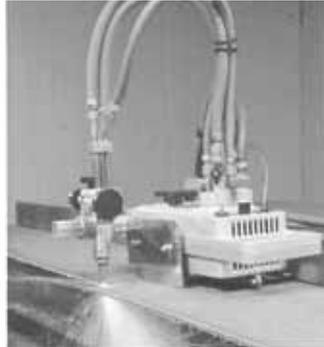
ProFIT für automatische Geradeschnitte durch Winkelprofilführung
