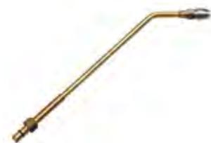
Zum zentrischen Anwärmen von Stahlbaukonstruktionen bei äußerster Flammenkonzentration. Der Anwärmkopf arbeitet mit optimaler Anwärmzeit. Hierdurch wird bei hoher Wärmedichte des Gasstrahles eine ausgeprägte konvergierende Flamme erzeugt. Infolge der großen Wärmeleistung soll der Anwärmkopf DK nur dort eingesetzt werden, wo kein Wärmestau erfolgt.
