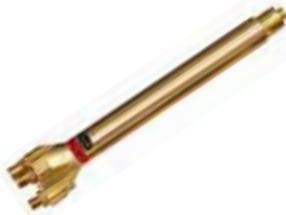
Passend zu den Schneiddüsenpaketen für Acetylen (AC + A-SD + A-HD 10) und Propan (PUZ 89 + P-SD + PY-HD 10), Katalogseite 42 und 44, Schaftlänge 220 mm/320. In die Brennerarten BIR 220/32 A+ und BIR 220/32 PMY+ ist ein patentiertes Sauerstoffkühlstromventil eingebaut. Dies bewirkt eine erhöhte Düsenstandzeit durch effiziente Kühlung der Schneiddüse während des Vorwärmens auf Zündtemperatur.
