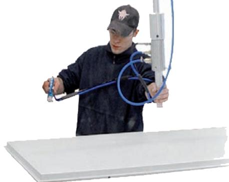
**für konventionelle lösemittelbasierende und wasserverdünnbare Beschichtungssysteme geeignet**
